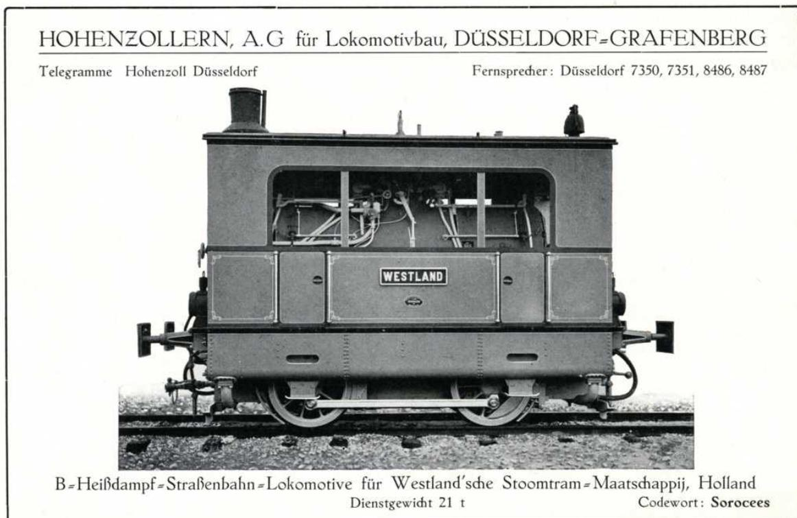
*Bild 11: Werkfoto der WTM-Lok WESTLAND - Das Namensschild ist offenbar nur für das Foto angebracht, denn die Maschinen dieser Bauserie 15-20 der WTM sollen lt. Heusingveld keine Namensschilder getragen haben, Repro aus einem Hohenzollern-Katalog, Smlg. Dr. Matthias Lentz*
