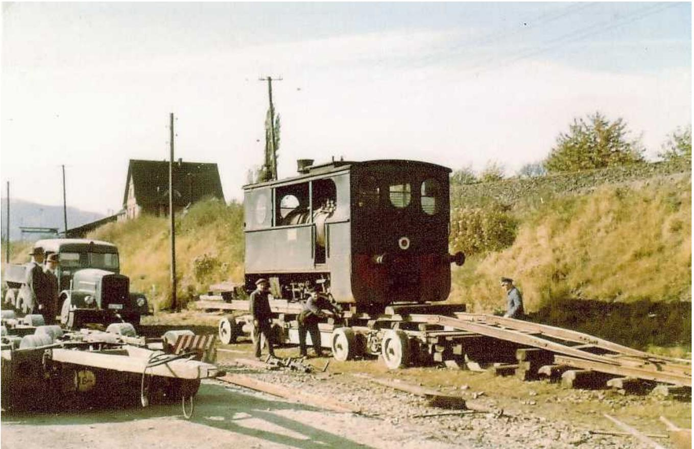
*Bild 54: Sie wird hier mit einem Straßenroller in Oberstadt zur Zerlegung gebracht, weil es aus dem Lokschuppen zu der Zeit schon keine Gleisverbindung mehr gegeben hatte, Smlg. Christa Schneider*
